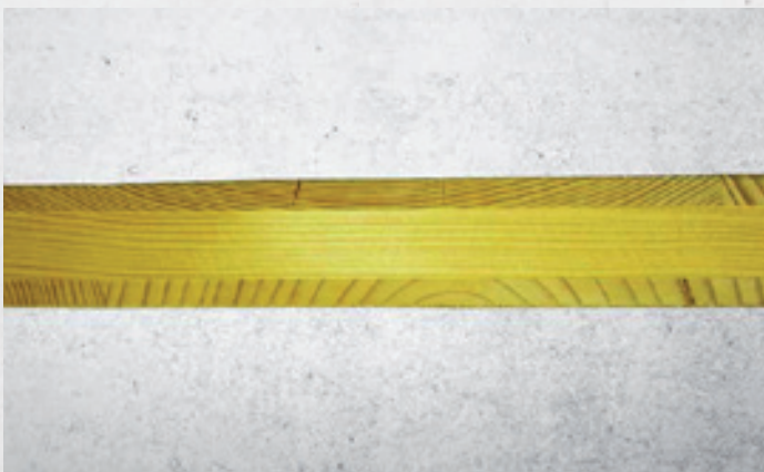
Geringe Verformung und reduzierte Rissbildung durch symmetrischen Plattenaufbau mit gleichstarken und speziell ausgerichteten Decklagen
